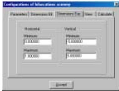
**Horizontal:** Configura las dimensiones reales en el eje horizontal de la región donde se analiza el comportamiento de los exponentes de Lyapunov de las bifurcaciones.
