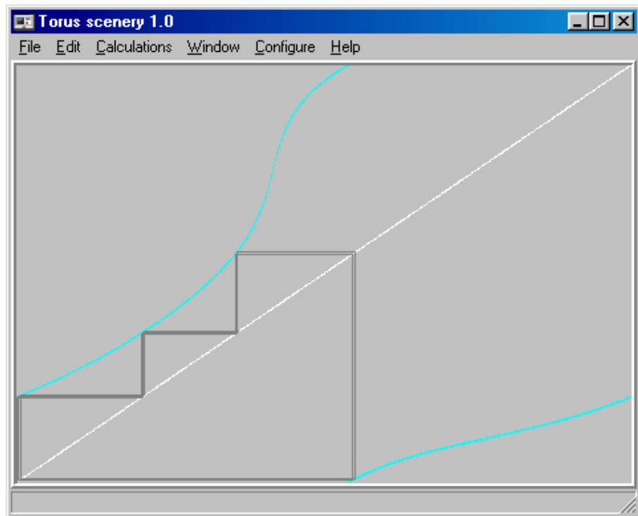
Desde este escenario gráfico se puede analizar la dinámica del sistema mediante estudio, en el toro plano, de las iteraciones de las funciones de fases de disparos generadas por las sucesiones de tiempos en que las soluciones de la ecuación diferencial llegan al umbral de disparos. El control de las acciones de este escenario es mediante un conjunto de menús cuyas opciones se describen en seguida:
