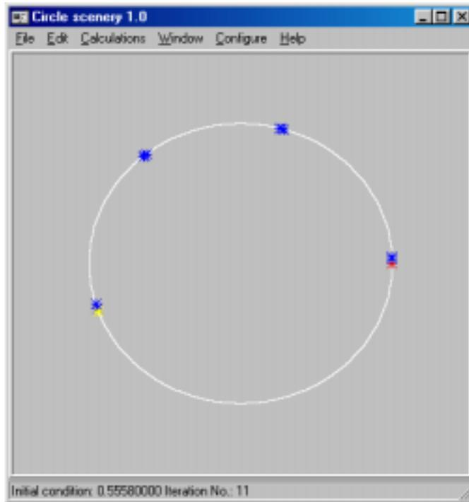
Desde este escenario gráfico se puede analizar la dinámica del sistema mediante estudio de las iteraciones de las funciones de la circunferencia en la circunferencia, generadas por los disparos de las curvas integrales de la ecuación diferencial al llegar al umbral de disparos. El control de las acciones de este escenario es mediante un conjunto de menús cuyas opciones se describen en seguida:
