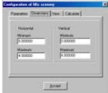
**Horizontal:** Configura las dimensiones reales en el eje horizontal de la región donde se analiza el comportamiento de los levantamientos.
